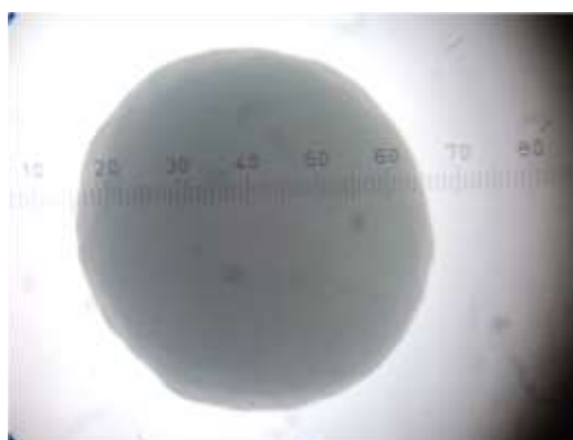
Gambar 5. Mikro kapsul Mikro kapsul Atenolol Formula 2 dengan Perbesaran 100 kali
