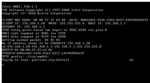
Gambar 4.1. Proses *Booting* *Diskless*
